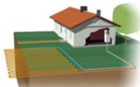
Impianto geotermico orizzontale a circuito chiuso
