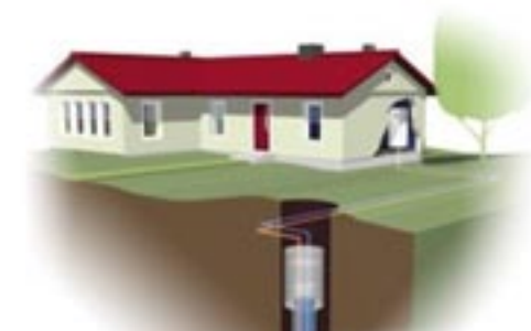
Impianto geotermico in falda con sonde chiuse
