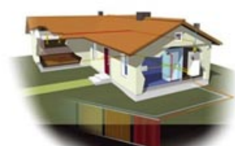
Impianto geotermico verticale a circuito chiuso
